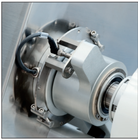
SISTEMA FRENATURA FILM / FREIN DE FILM
